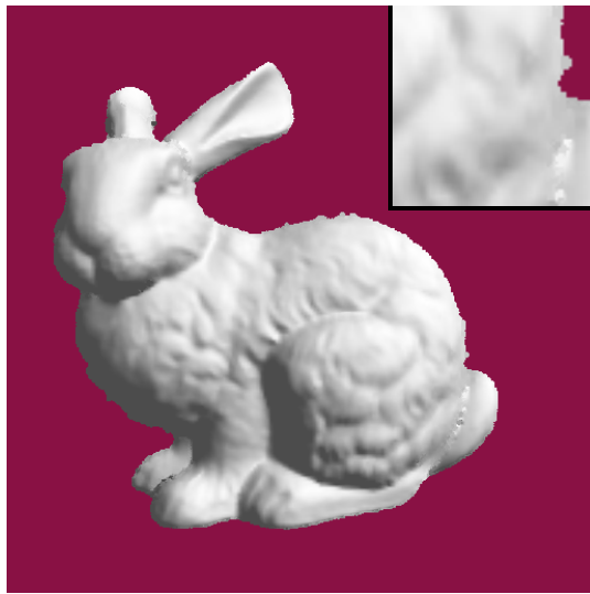
図 6: イメージベースポイントレンダリングでの "Bunny" のレンジデータの描画結果 .
